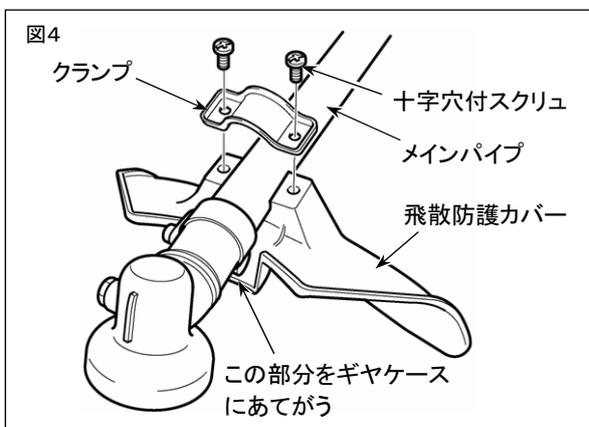
付属の飛散防護カバーの先端をギヤケースにあて、付属のクランプでメインパイプに取り付け、十字穴付きスクリュー (M5×25) 2本で均等に締め付けてください。
