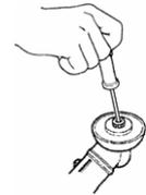
3. 刈刃を、文字のある面をギヤケース側にして刃受け金具にのせ、刈刃の穴を刃受け金具の凸部に正しくはめてください。
