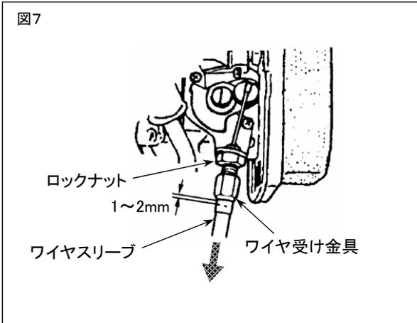
スロットルワイヤの遊びは、スロットルレバーを完全に戻した位置にしてワイヤ受け金具から出ているワイヤスリーブを指でつまんで軽く引いた時に、**1~2mm**動く程度であれば適正です。遊びが大き過ぎたり小さ過ぎる場合は、下記の要領で再調整してください。
