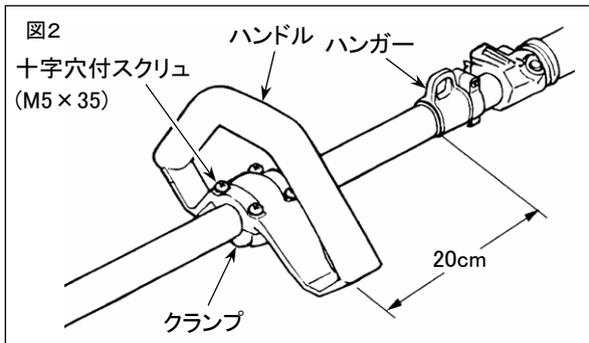
ハンドル本体とクランプでメインパイプを挟み、付属の十字穴付スクリュー (M5×35) 4本で均等に締め付けてください。
