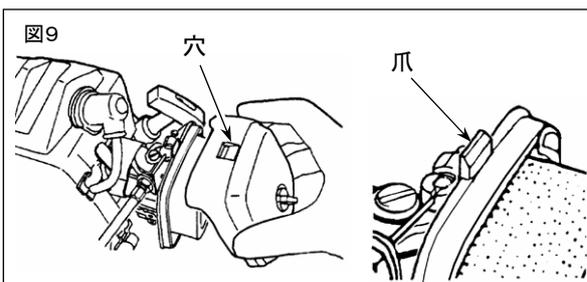
3. エアクリーナカバーを元通り取り付けます。エアクリーナ本体上部の爪をカバーの穴に入れてからノブを締め込んでください。
