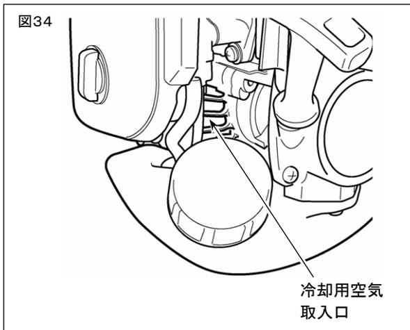
25時間使用毎に冷却用空気取入口やシリンダの冷却フィン回りを点検し、付着したゴミを取り除いてください。
