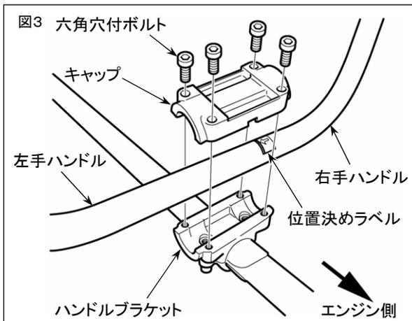
1. ハンドルを、スロットルレバーが付いている方からエンジン側から見て右側になるようにしてからブラケットのくぼみに収め、位置決めラベルの矢印をブラケットの右端面に合わせてください。
