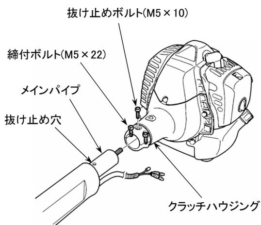
1. クラッチハウジング端部中央の抜け止めボルト (M5×10) を、付属の六角レンチでゆるめて取り外してください。
