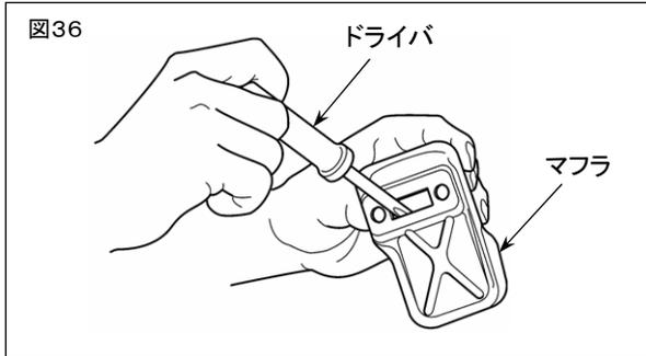
1. マフラを外して、排気口にドライバを入れてカーボンを落してください。同時にマフラ出口のカーボンも落してください。
