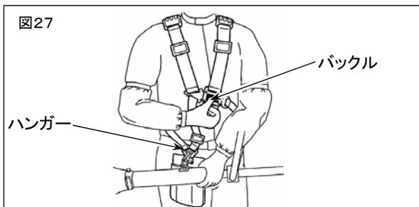
胸のバックル部を押してください。結合金具が外れます。
