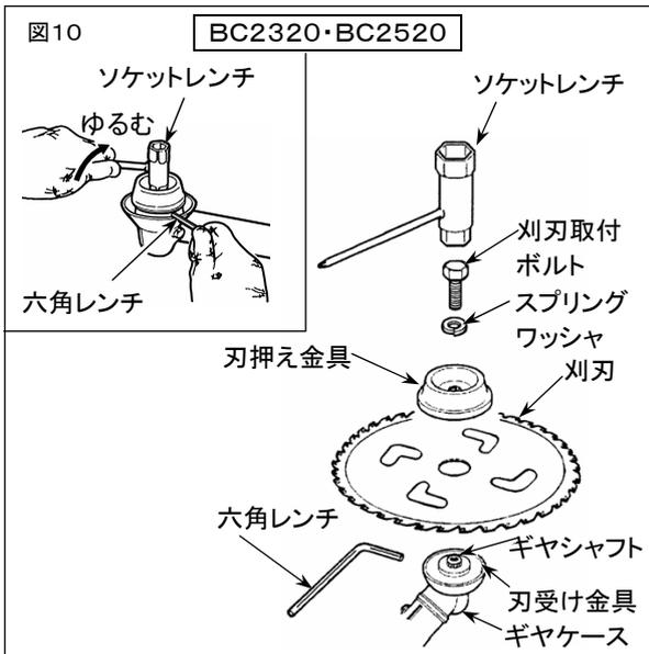
1. ギヤシャフトに仮締めされている刈刃取付ボルト(左ネジですので、右に回すとゆるみます)と、刃押え金具を取り外してください。
