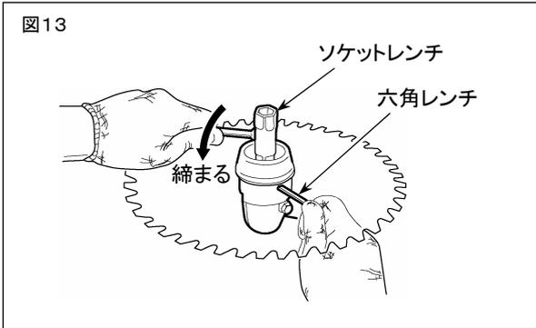
7. 六角レンチで回り止めをしてから、刃取付ボルトにスプリングワッシャをはめて、ソケットレンチで確実に締め付けてください。
