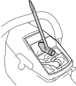
注意!スパークプラグは必ず推奨タイプのものを使用してください!不適正なスパークプラグは、ピストンやシリンダーの損傷の原因となります。スパークプラグが正しく装着されていることを確認します。
