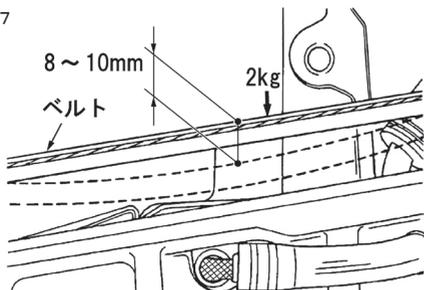
定期的に駆動ベルトの張り具合と摩耗度合を点検し、異常が見られた場合は調整または交換してください。
