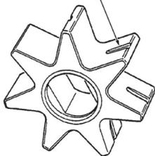
駆動スプロケットの歯の片面の摩耗が0.5mm以上になったら次の手順で裏返しに取り付けてください。(図31)
