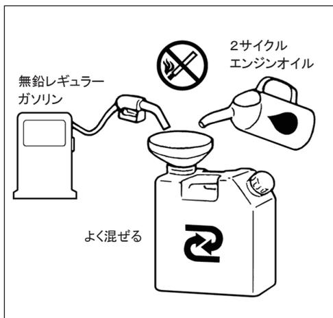
燃料は、自動車用無鉛ガソリンと空冷2サイクルエンジン用オイルを下記割合で混合容器に入れ、容器を振ってよく混ぜ合わせたものを使用してください。
