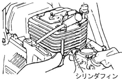
このエンジンは空冷式です。冷却用の空気取入口やシリンダフィンの中にゴミが詰まるとエンジンが過熱し、故障の原因となります。時々点検し、ゴミを取り除いてください。
