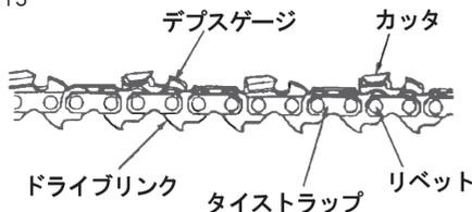
**デプスゲージ**：カッタ前部のデプスゲージは、カンナの台に相当し、チェンのタイプにより適正高さが設定されています。低くし過ぎるとカッタにかかる抵抗が増え、ソーチェンの寿命が短くなります。
