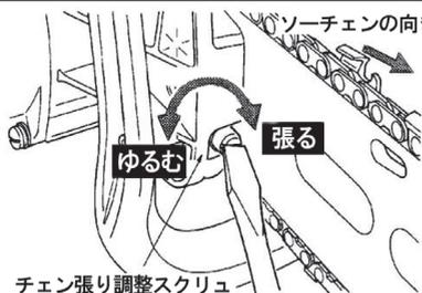
4. ガイドバー先端部を持ち上げながら、チェーン張り調整スクリューを時計回りに回してソーチェンを張ってください。(図2)
