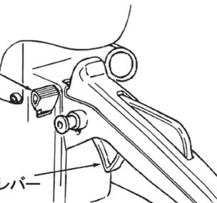
1. スロットルレバーを完全に戻し、低速でしばらく運転してください。
