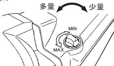
チェンオイルの吐出量調整は、機体上部右側の調整ツマミ（図10）で行います。ツマミを右に回すと吐出量が減り、左に回すと量が増えます。作業条件に応じて最適位置にセットしてください。
