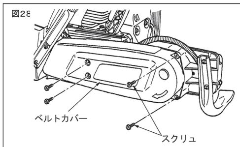
1. 六角穴付スクリュー4本をゆるめてベルトカバーを取り外してください。(図28)
