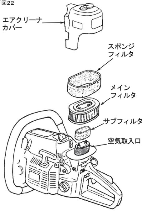
エアクリーナには切断時に発生する粉塵が大量に付着します。一日の作業終了時に必ず点検し、次の要領で清掃してください。(図22)
