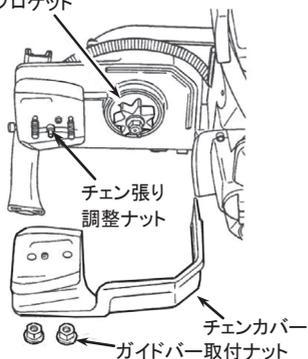
1. 梱包箱から本体および付属品を取り出し、本体のガイドバー取付ナットを外してチェーンカバーを取り外してください。(図1)
