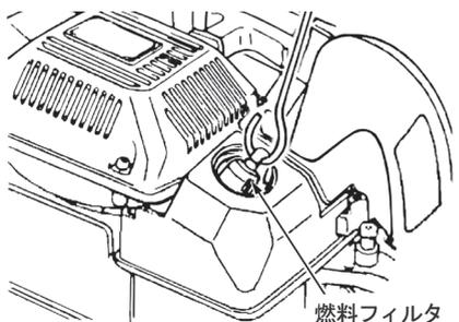
25時間使用毎を目安に、燃料タンクから燃料フィルタを取り出し、付着したゴミを取り除いてください。
