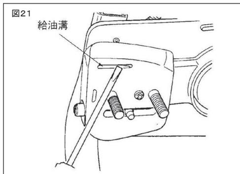
ガイドバー取付部の給油溝に詰まった土を取り除いてください。(図21)
