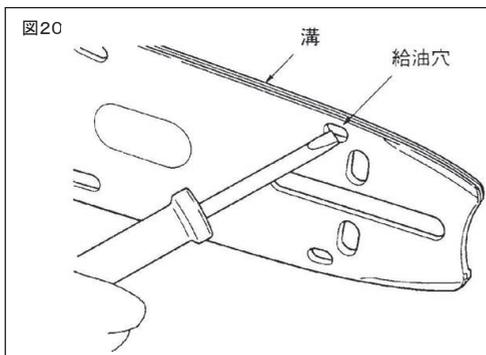
ガイドバーを取り外し、チェンオイルの給油穴と溝に詰まった土を取り除いてください。(図20)
