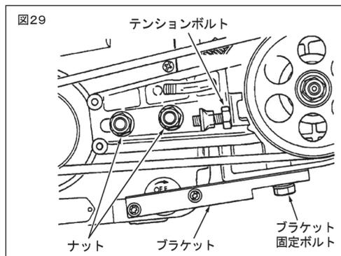
4. 調整が終わったら、始めにゆるめたボルトナットを元通り締め付け、テンションボルトを右に回してゆるみ止めしてください。
