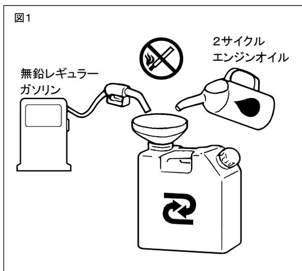
燃料は、自動車用無鉛ガソリンと空冷2サイクルエンジン用オイルを下記割合で混合容器に入れ、容器を振ってよく混ぜ合わせたものを使用してください。
