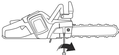
4. コンビネーションレンチを使用してバーナットを締め込むと同時にガイドバーの前方を持ち上げます。
