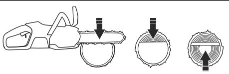
**警告：** ソーチェンが幹に挟み込まれた場合は、モーターを停止します。てこなどで切り口を広げ、本製品を抜き取ります。本製品を手で引き抜こうとしないでください。本製品が突然抜けて負傷する危険があります。
