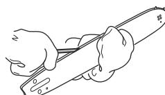
4. ガイドバーの溝に摩耗がないか調べます。摩耗がある場合は、ガイドバーを交換します。
