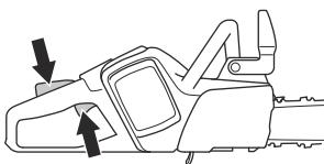
2. パワートリガーロックを前方 (A) に押してから、押し下げます (B)。パワートリガーロックをハンドルの方向へ押し、指を放すと元の位置に戻ることを確認します。
