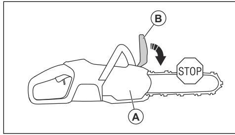
チェンブレーキの動作は、キックバックの強さと本製品の位置によって異なります。キックバックゾーンが身体から最も離れた位置にあるときに非常に強いキックバックが起こった場合、イナーシャ機構によりチェンブレーキがかかります。キックバックの力が弱く、キックバックゾーンが身体に近い場合は、左手を使用して手動でチェンブレーキをかけます。
