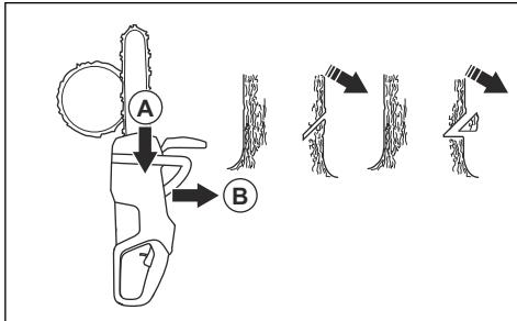
2. 受け口線が完全に水平で、伐倒方向に対して直角(90°)であることを確認してください。受け口線は、2つの受け口が接触するポイントを通ります。
