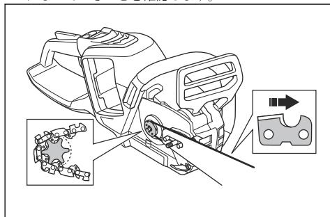
5. ドライブスプロケットカバーを取り付けて、チェン調整ピンをガイドバーの穴に通します。
