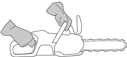
3. 最大出力にして、左手首をフロントハンドガードに対して傾けてチェンブレーキをかけます。ソーチェンがすぐに停止する必要があります。
