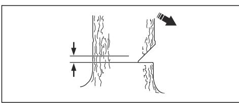
**警告 :** ガイドバー先端を使用して切断するときは注意してください。突っ込み切りをするときは、ガイドバー先端の下部を使用して切断を開始します。
