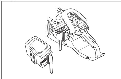
3. バッテリーにひびがなく、損傷していないことを確認します。
