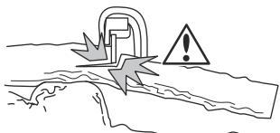
1. 幹を押し切りで約 1/3 切断します。
