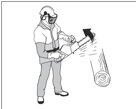
キックバックは、ガイドバーのキックバックゾーンに物体が接触したときにのみ起ります。キックバックゾーンに何も接触しないようにしてください。
