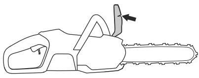
2. フロントハンドガードが自由に動き、製品に安全に取り付けられていることを確認します。
