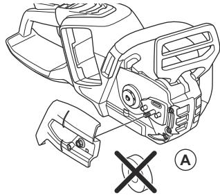
3. バーボルトの上にガイドバーを取り付けます。ガイドバーを最後部の位置まで移動します。ソーチェンをドライブスプロケットの上まで持ち上げて、ガイドバーの溝にはめます。ガイドバーの上端から装着作業を始めてください。
