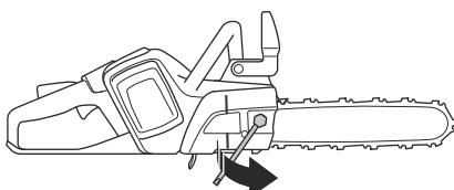
2. ガイドバーの前を持ち上げて、チェン張りネジを回します。コンビレンチを使用してください。
