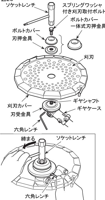
3. スプリングワッシャ付き刃取付ボルト、刃押金具およびボルトカバーを外してください。
