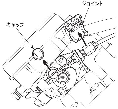
3. ワイヤ受金具を固定しているジョイントとワイヤの端子外れ防止キャップを取り外してください。
