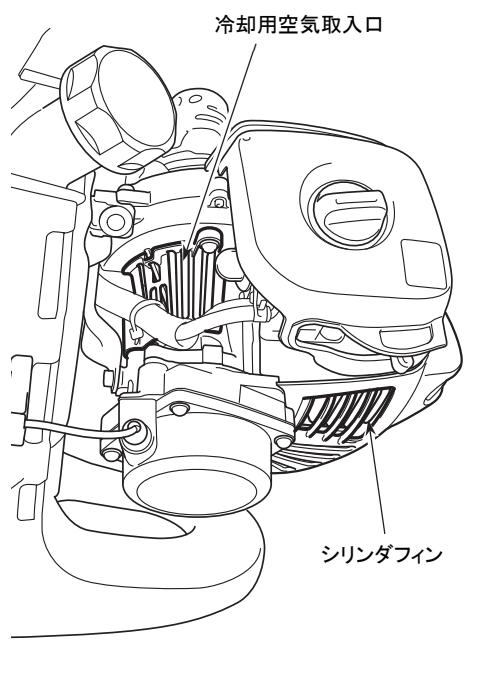
25時間使用毎に冷却用空気取入口やシリンダの冷却フィン回りを点検し、付着したゴミを取り除いてください。
