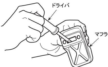
1. マフラを外して、排気口にドライバを入れてカーボンを落してください。
