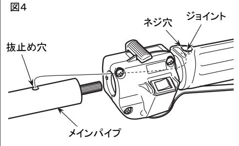
3. メインパイプを軽く左右に回しながらメインパイプの抜止め穴とジョイントのネジ穴が合うようにジョイントに押し込んでください。
