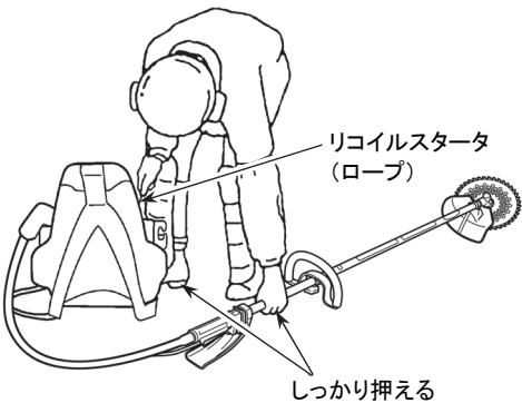
4. 機体を安定した地面に置き、刈刃の周囲の安全を確かめてから、右足でフレーム、左手でメインパイプを抑えながら右手でスタートノブを引いてください。
