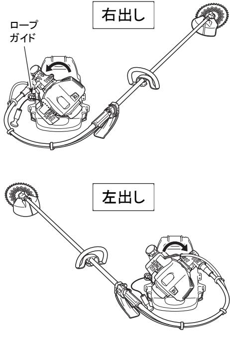
**補足** この刈払機は右出し、左出し両方の操作が可能です。右出しがから左出し、または左出しがから右出しひに竿を持ち換える場合は、必ずエンジンを停止し、背負いフレームを地面に降ろしてから竿の向きを変え、背負い直してください。
