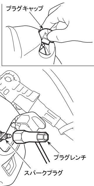
25時間使用毎を目安に、スパークプラグを取り外して電極を点検し、汚れている場合はワイヤーブラシなどで取り除いてください。
