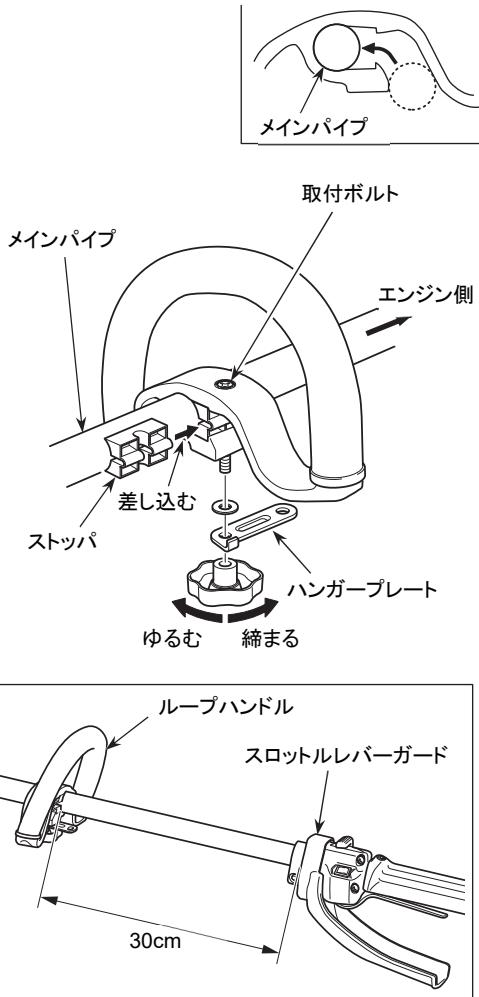
1. 付属のループハンドルのグリップ、ワッシャおよび取付ボルトを取り外し、ストップを取り外してください。
