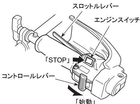
1. コントロールレバーを「始動」位置に戻し、スロットルレバーを離してください。
