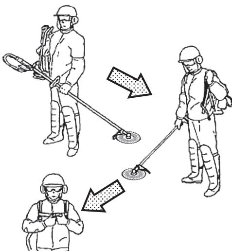
1. エンジンをかけ、暖機運転をしてからスロットルレバーをアイドリング位置に戻して刈刃が回転していないことを確認してください。
