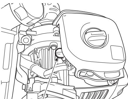
2. キャブレタ下部のプライマポンプでキャブレタに燃料を満たします。燃料が透明なパイプを通ってタンクに戻り始めるまで、ポンプを指で押して離す操作を繰り返してください。
