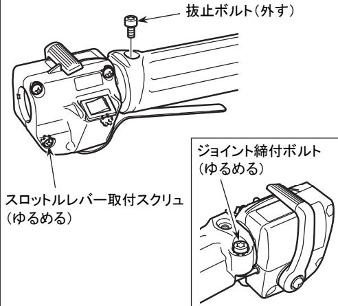
1. ジョイント端部中央の抜止ボルト(M5×9)を取り外し、ジョイント締付ボルト(M5×20)およびスロットルレバー取付スクリュ(M4×20)4本をゆるめてください。
