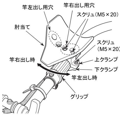
1. 上クランプおよび下クランプをスクリュ(M5×20)2本でしっかりと締め付けてください。
