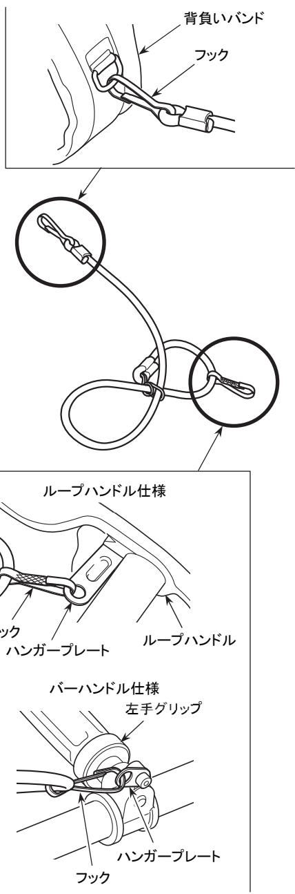
付属の吊りバンドの取付けフックを、背負いバンドの吊りバンド取付金具に取り付け、バンドを使いやすい長さに調整してください。
