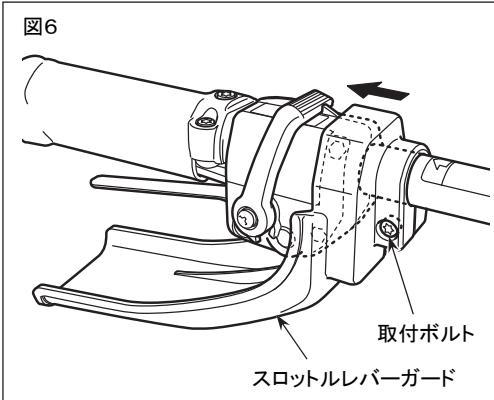
7. スロットルレバーガードがスロットルレバーに当たる位置までずらし、スロットルレバーガード取付ボルト(M5×25)を締め込んでメインパイプに確実に固定してください。
