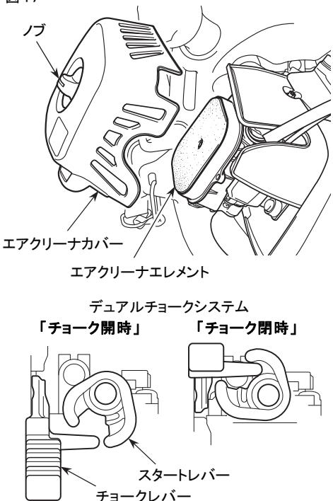
25時間使用毎を目安に、エアクリーナカバーのノブをゆるめてカバーを取り外し、内部のゴミを取り除いてください。
