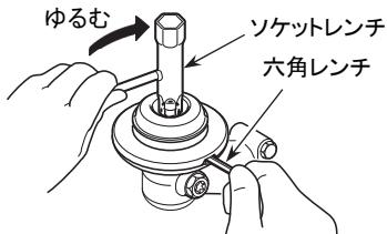
2. ギヤケースを裏返し、付属のソケットレンチで刈刃取付ボルトを時計方向に回してゆるめてください。
