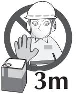
4. 在處理燃料時要小心對付。要擦乾淨全部溢出液體，將鏈鋸移開加油點至少3米，然後再啟動引擎。
