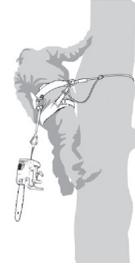
當將鏈鋸從一個聯結點移到另一個聯結點時，在從原聯結點拆除前，操作員應確保其在新位置處的安全。
