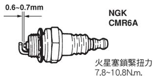
以鋼絲刷清潔電極。如有需要，將間隙重設為 0.6-0.7 mm。
