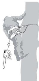
チェンソーの取り付け位置を他の位置に移動する場合、前の取り付け位置からチェンソーを離す前に、新しい位置でチェンソーが固定されていることを確認してください。
