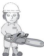
22. キックバックを防止してください。キックバックとは、ソーチェンが高速回転中にガイドバーの先端部が付近のものに触れた際に、反作用で機体が逆方向にはね返される現象をいいます。キックバックは、チェンソーの制御不能につながり危険です。
